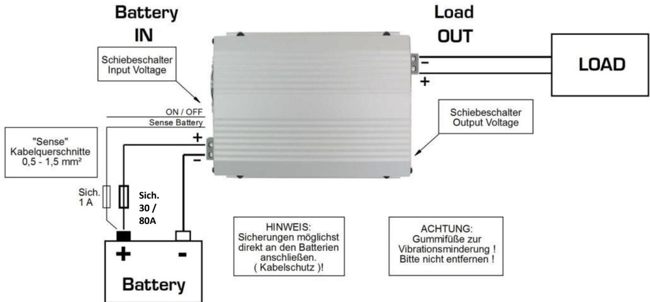
**Zuerst den Gleichspannungs-Wandler anschließen, dann die Batterie.**
