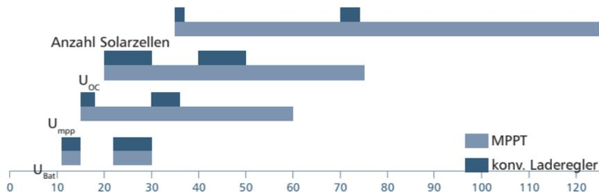
Im Vergleich zu Laderegler ohne MPPT können MPP-Tracker für einen weiten Modulbereich verwendet werden. Mit einem MPP Tracker ist man nicht mehr auf die Modulspannung und Stringgröße angewiesen. Die Modulspannung kann weit von der Batteriespannung abweichen.
