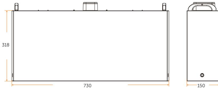
Abbildung 2-9 Abmessungen: Batteriemodul (TP-HS50E)
