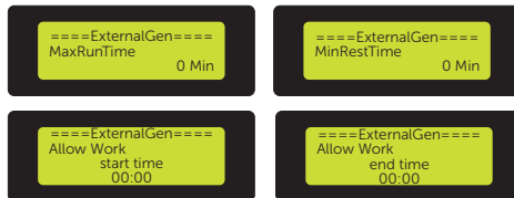
Abbildung 9-79 MaxRunTime, MinRestTime, Allow Working Period einstellen
