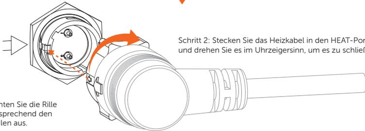
Schritt 2: Stecken Sie das Heizkabel in den HEAT-Port, und drehen Sie es im Uhrzeigersinn, um es zu schließen.
