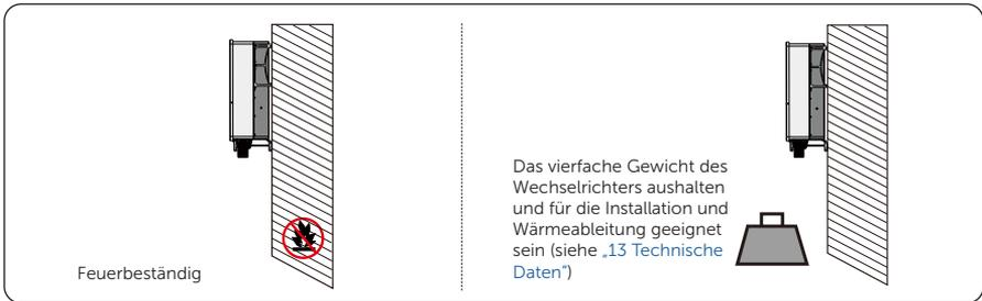
Abbildung 5-3 Anforderung an den Installationsträger
