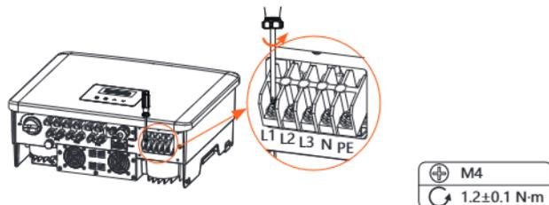
g) Schließen Sie die Adern L1, L2, L3, N und PE an den Wechselrichter an und ziehen Sie die Schrauben der Aderenden mit einem Kreuzschraubendreher fest.
