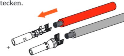
d) Verwenden Sie die Crimpzange für PV-Klemmen, um die Stiftkontakte so zu crimmen, dass der abisolierte Abschnitt des PV-Kabels fest mit den Stiftkontakten in Kontakt kommt.
