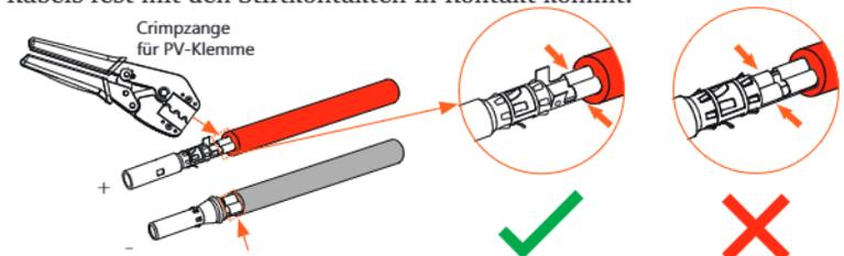
e) Lösen Sie die Kabelmutter von den PV-Steckverbindern. Fädeln Sie das Kabel durch die Kabelmutter und die Stecker.
