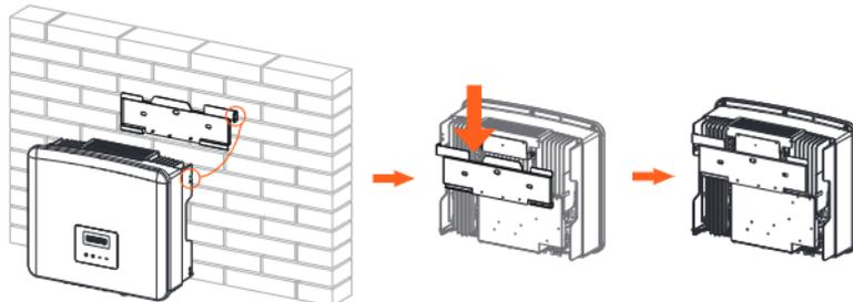
➤ Schritt 3: Ziehen Sie den Wechselrichter und die Halterung fest.
