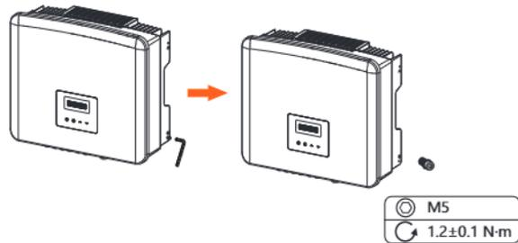
f) Ziehen Sie die Erdungsschraube mit einem Inbusschlüssel an, wie in der Abbildung unten gezeigt.
