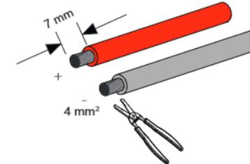
c) Führen Sie den abisolierten Abschnitt in die positiven und negativen Stiftkontakte ein und stellen Sie sicher, dass alle Drähte in den Stiftkontakten stecken.
