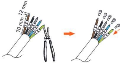
e) Crimpen Sie die R-Typ-Klemmen mit einer Crimpzange, ziehen Sie die Klemmenhülsen über die gecrimpten Abschnitte der R-Typ-Klemmen und schrumpfen Sie sie mit einer Heißluftpistole, damit sie fest mit den Klemmen verbunden werden können.
