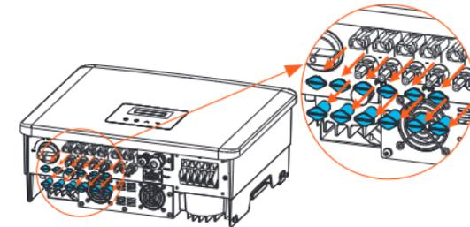
j) Schließen Sie an den entsprechenden Anschluss (+ und -) des Wechselrichters an und versiegeln Sie die nicht verwendeten PV-Klemmen mit den Klemmenkappen.
