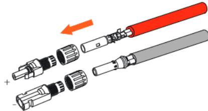
f) Drücken Sie das Kabelpaar in die Stecker. Ein „Klick“ ist zu hören, wenn das Kabel richtig und vollständig eingesteckt ist.
