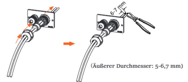
d) Stecken Sie die abisolierten Abschnitte unter Beachtung der PIN-Definitionsregeln in die entsprechenden Stifte der Klemmleiste und ziehen Sie die Schrauben fest.
