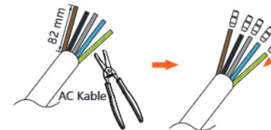
d) Isolieren Sie die Drähte 12 mm ab und setzen Sie die R-Klemmen für den Wechselstromanschluss auf die abisolierten Abschnitte.
