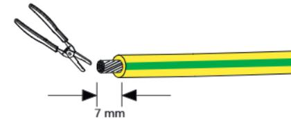
c) Ziehen Sie die Klemmhülse über das Kabel und stecken Sie den abisolierten Teil in die R-Klemme zur Erdung.
