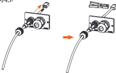
e) Schließen Sie das Kabel an den COM-Port des Wechselrichters an. Schieben Sie dann die Abdeckung in die richtige Position und ziehen Sie die Schrauben fest.
