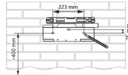
b) Bohren Sie an den markierten Stellen Bohrungen mit einer Tiefe von mindestens 60 mm.
