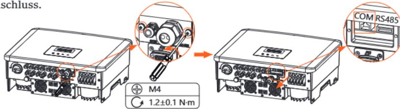
b) Lösen Sie die Mutter und entfernen Sie den Stopfen des COM-Anschlusses.
