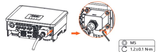
i) Ziehen Sie die wasserdichte Befestigungsmutter an.
