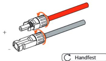
h) Schalten Sie vor dem Anschluss an den Wechselrichter den Schalter der PV-Strings ein und messen Sie mit einem Multimeter die Leerlaufspannung des Pluspols und des Minuspols des PV-Kabels, und stellen Sie sicher, dass die Leerlaufspannung  $\leq$  der max. Gleichspannung.
