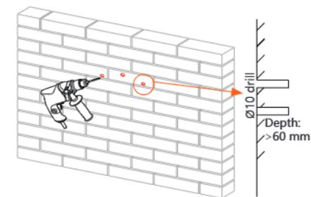
c) Setzen Sie die Dehnungsrohre in die Löcher ein und klopfen Sie die Dehnungsrohre mit einem Gummihammer in die Wand.
