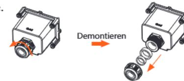
b) Wählen Sie die entsprechende Anzahl der Dichtungsringe entsprechend dem Außendurchmesser des Kabels. Lassen Sie das Kabel nacheinander durch die Befestigungsmutter, den/die Dichtungsring(e) und die wasserdichte Abdeckung laufen.
