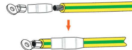
d) Crimpen Sie sie mit einer Crimpzange, ziehen Sie die Klemmhülse über den gecrimpten Teil der R-Klemme und schrumpfen Sie sie mit einer Heißluftpistole, so dass sie fest mit der Klemme verbunden werden kann.
