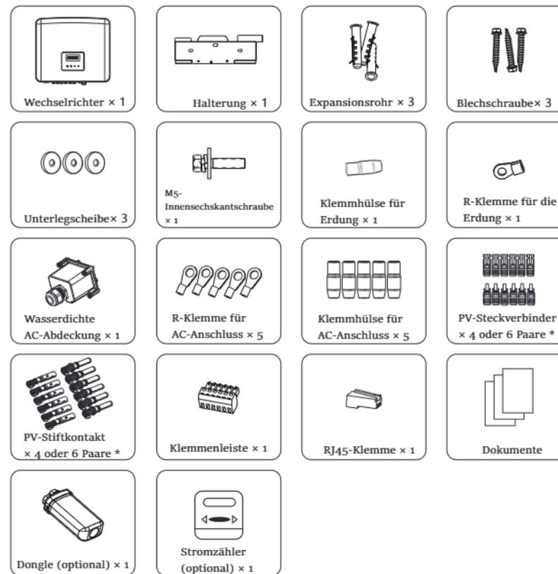
\* Positiv x 4 und Negativ x 4 für Wechselrichter mit zwei MPPT-Eingängen, Positiv x 6 und Negativ x 6 für Wechselrichtern mit drei MPPT-Eingängen
