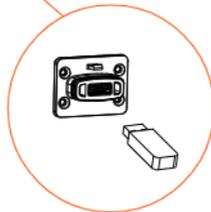
3) Stecken Sie dann die U-Disk in den Dongle-Anschluss an der Unterseite des Wechselrichters. Schalten Sie dann den DC-Schalter ein und schließen Sie den PV-Steckverbinder an; auf dem LCD wird ein Bild wie unten angezeigt.
