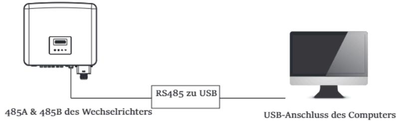
Das Produkt ist mit einer Modbus-Schnittstelle über den RS485-Port ausgestattet. Die Modbus-Schnittstelle kann über ein RS485-USB-Kabel oder ein externes Modbus-Steuerggerät an SCADA-Systeme für den industriellen Einsatz angeschlossen werden und hat folgende Aufgaben:
