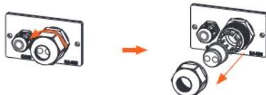
c) Fädeln Sie das/die vorbereitete(n) Kommunikationskabel entsprechend der tatsächlichen Anwendungssituation ein und isolieren Sie das/die Kabel ab.
