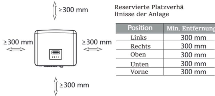
Der Abstand des Installationsraums für mehrere Wechselrichter ist wie folgt:
