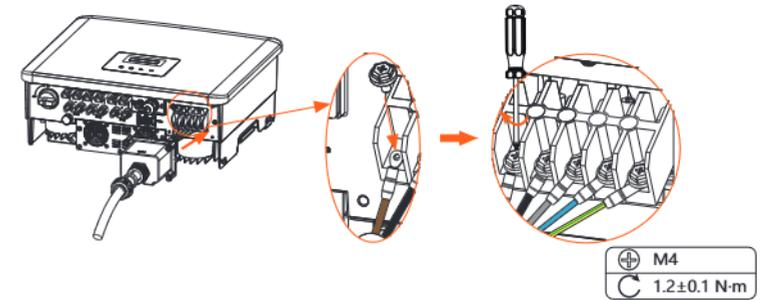
h) Richten Sie die wasserdichte Abdeckung aus und ziehen Sie die vier Schrauben mit einem Inbusschlüssel fest.
