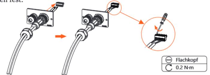
e) Stecken Sie den Klemmenblock in den RS485-Anschluss des Wechselrichters. Schieben Sie dann die Abdeckung in die entsprechende Position und ziehen Sie die Schrauben fest.
