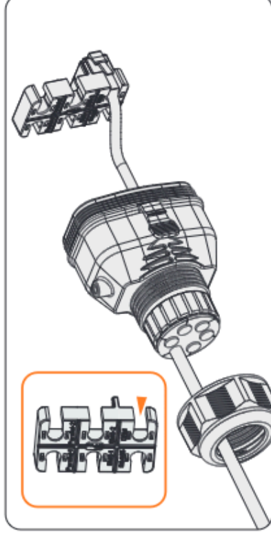
Abbildung 8-47 RJ45-Klemme an dem Kabelhalter anbringen
