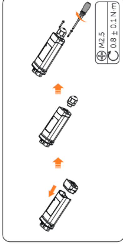
Abbildung 8-68 Den Dongle montieren
