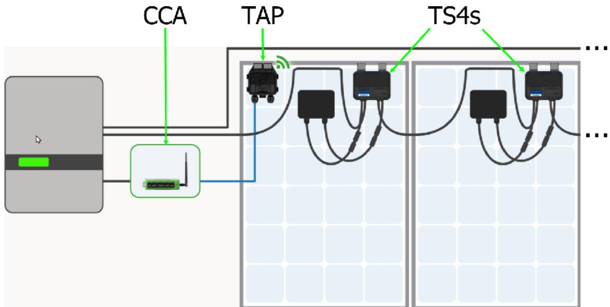
Dieses Handbuch erklärt die Installation von TS4-A/M/O MPE, TAPs und der CCA. Anweisungen zur Installation des TS4-A-F/2F MPE, der mit dem Transmitter zur schnellen Sicherheitsabschaltung (Rapid Safety Shutdown, RSS) verwendet wird, finden Sie auf der [Download-Seite](#) von Tigo Energy.
