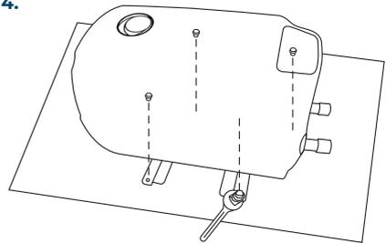
Waagrechte und senkrechte Montage des photovoltaischen Boilers ist möglich.
