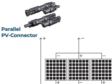
*Nur ein paralleler PV-Modulanschluss ist erlaubt!
