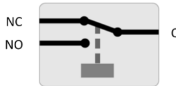
Interner Betrieb des programmierbaren Relais
