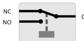
Relaiskonfiguration (nicht angezogen).
