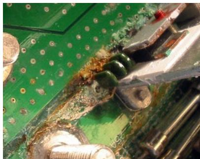
*Korrosion durch Salzwasser, sowohl als Rost (braun) als auch als Kupferkorrosion (grün) sichtbar*
