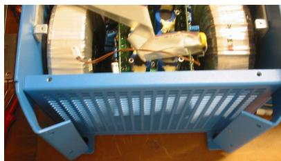
*Mechanische Beschädigung durch unsachgemäße Transportverpackung*
