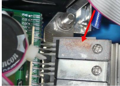
*Rost oder Korrosion an metallischen Teilen, dies ist ein Zeichen für kondensierende Feuchtigkeit oder Beschädigung durch Wasser*
