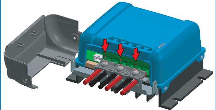
SCHRITT 2: Nachdem Sie den MPPT an der Wand befestigt haben, sichern Sie die Kabel (max. Ø5 mm).
