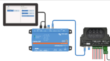
SmartSwitch DC4 am Ende des VE.Can-Netzwerks angeschlossen
