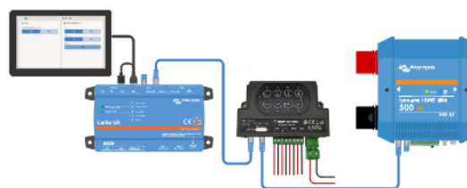
SmartSwitch DC4 durchgeschleift
