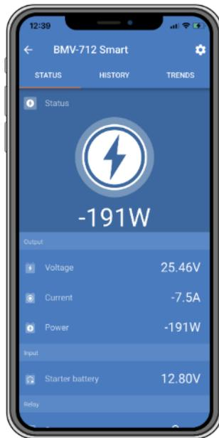
*Der Statusbildschirm der VictronConnect App eines Batteriemonitors, der im Gleichstrommonitormodus betrieben wird.*
