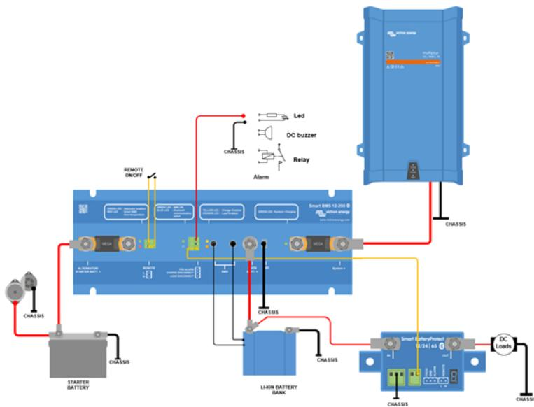
Abbildung 2: Anwendungsbeispiel mit einem MultiPlus und einem BatteryProtect
