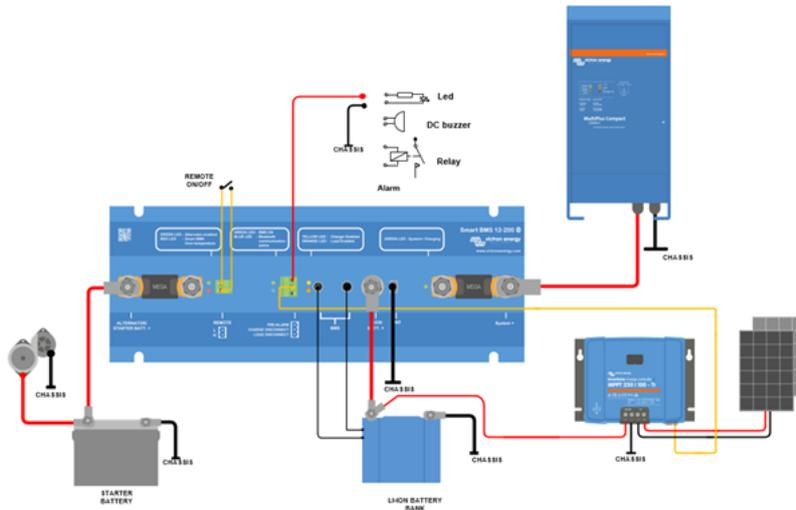
Abbildung 1: Anwendungsbeispiel mit einem MultiPlus und einem MPPT
