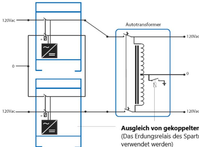
**Ausgleich von gekoppelten Wechselrichtern**
