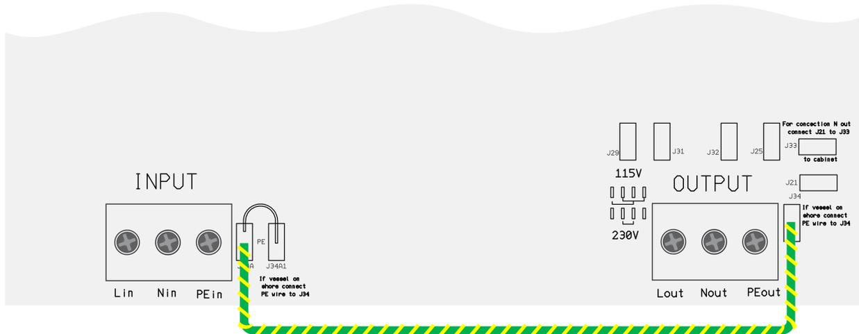
Die Wechselstromeingangserdung ist mit der Wechselstromausgangserdung verbunden, wenn sich das Schiff im Winter oder zur Wartung nicht im Wasser (an Land) befindet.
