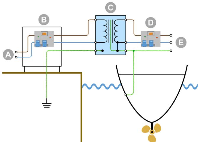
Die Landmasse ist von der Schiffsmasse isoliert, und galvanische Korrosion, die von der Landverbindung ausgeht, wird verhindert.
