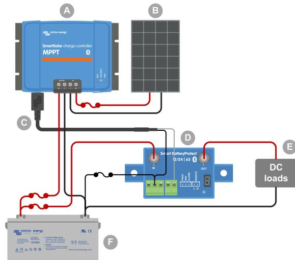
Verkabelungsbeispiel – Erstellen eines virtuellen Lastausgangs mit einem BatteryProtect.
